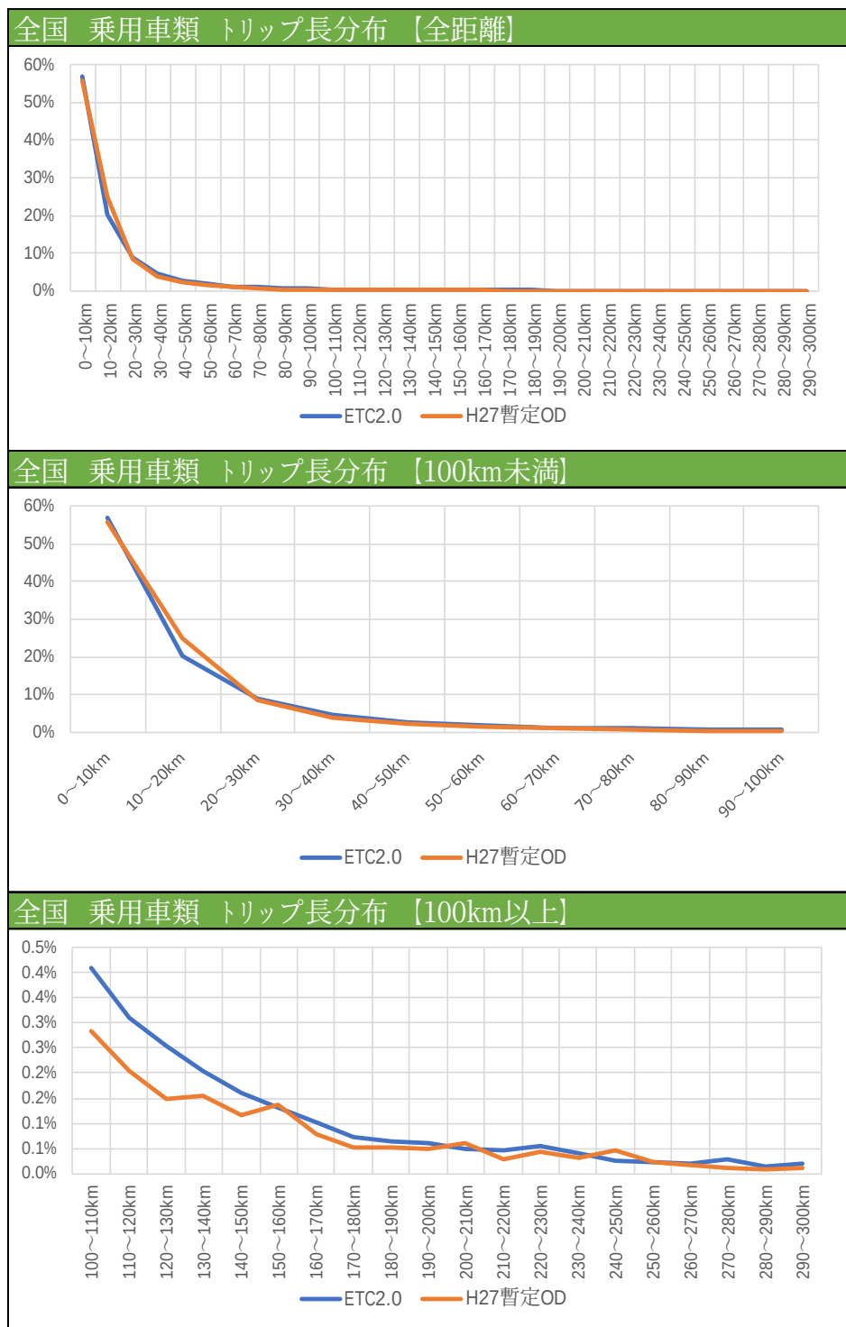
図 E T C 2. 0 プローブおよびH 2 7 暫定O Dにおけるトリップ長分布（乗用車類）
