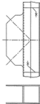
図一解 13.3.2 ガセットと弦材等のウェブとを一体にした形式
