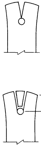
(a) せん断が支配的な場合 (b) 曲げが支配的な場合 図-解 7.3.6 縁端部の破壊形式
