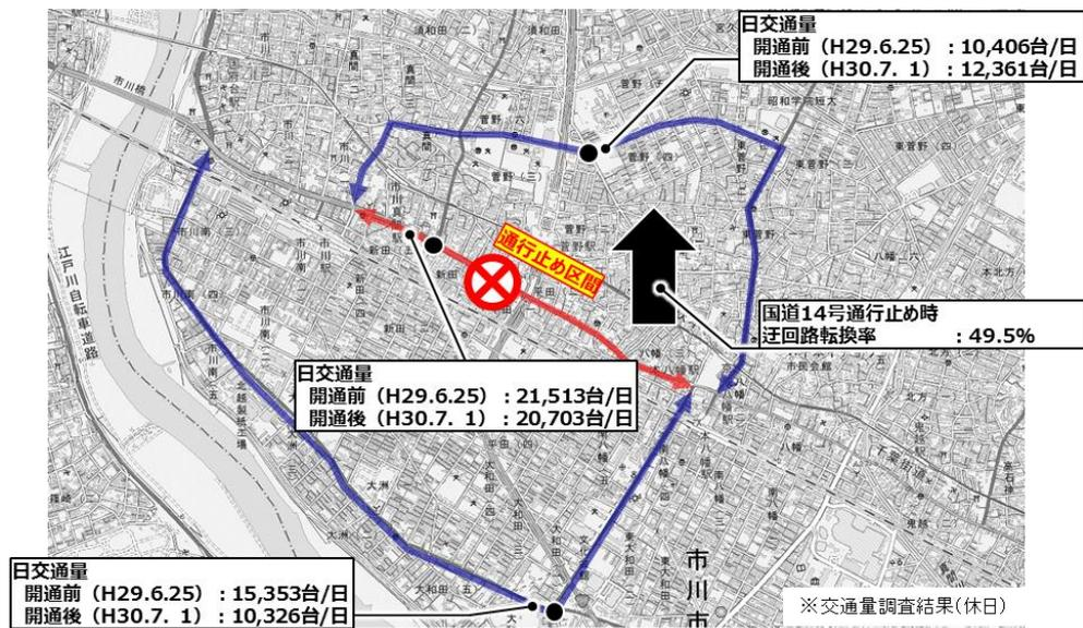
図 5-112 通行止めなし時の国道 14 号と迂回路の交通量 (パターン①)
