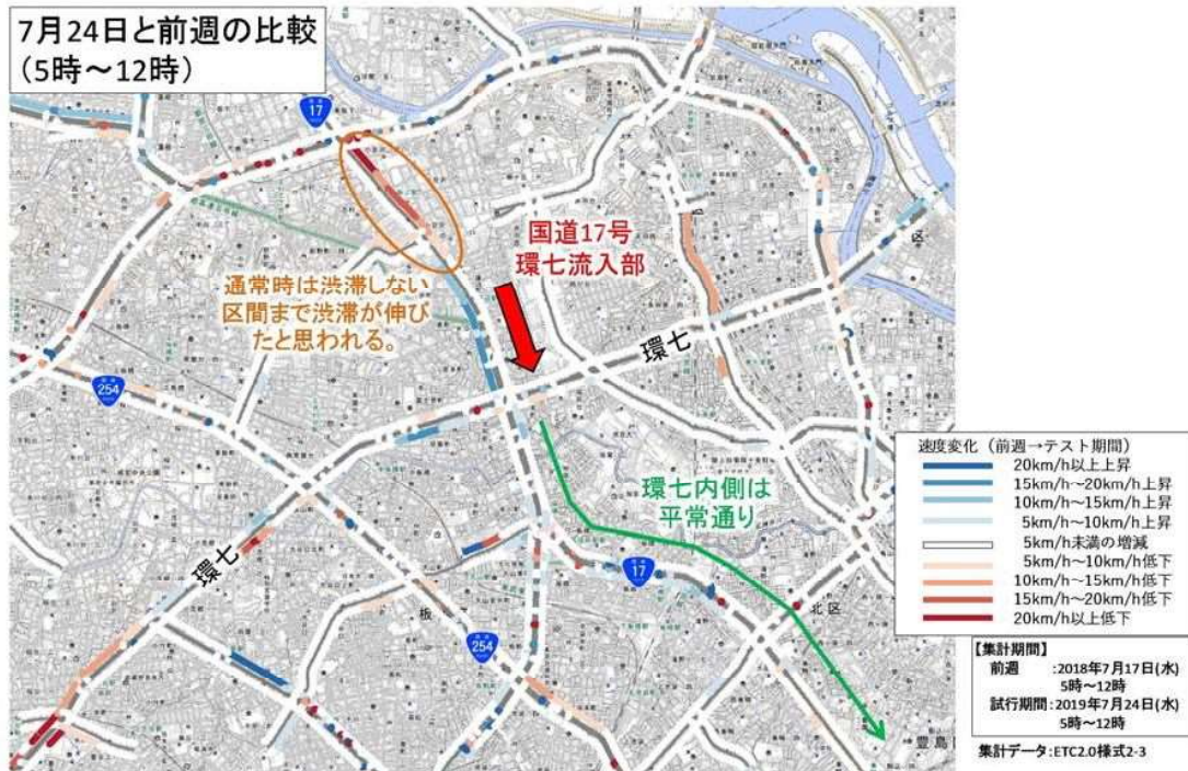
図 3-44 TSM1 日目における環七と国道17号の交差部付近の速度差分
