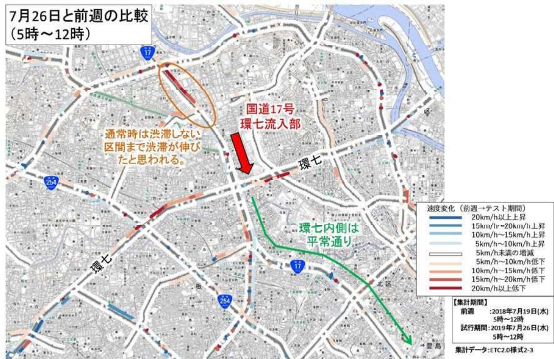
図 3-45 TSM2 日目における環七と国道17号の交差部付近の速度差分
