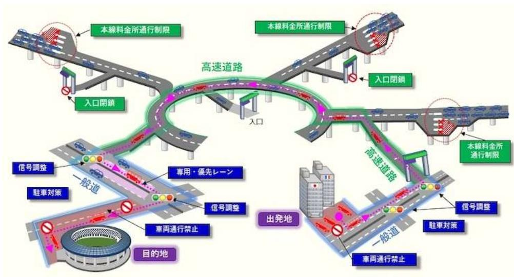
図 4-4 TSM 実施による交通量の抑制・分散イメージ
