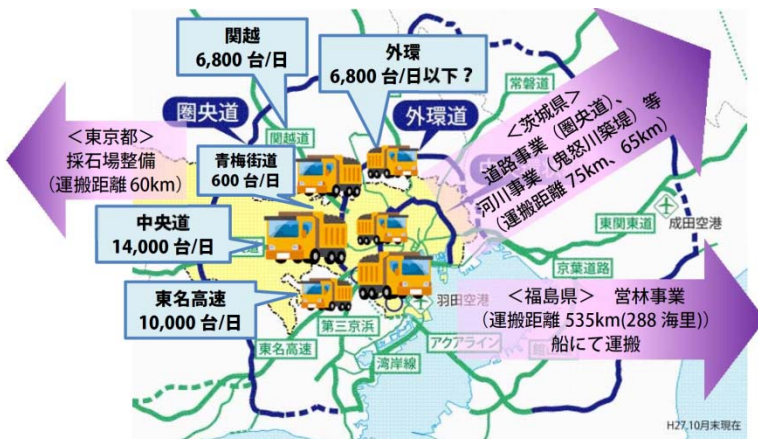
図1 外環で想定される工事車両の運行ルートと交通量
