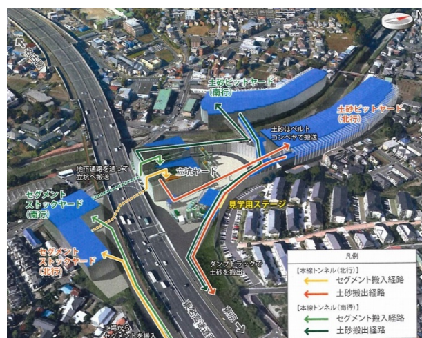
図5 東名JCT工事現場の立坑、整備中のセグメントや土砂のヤード、工事車両の運行ルート 出典: 国土交通省資料
