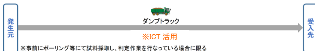
図 4-11 発生土の代表的な運搬法
