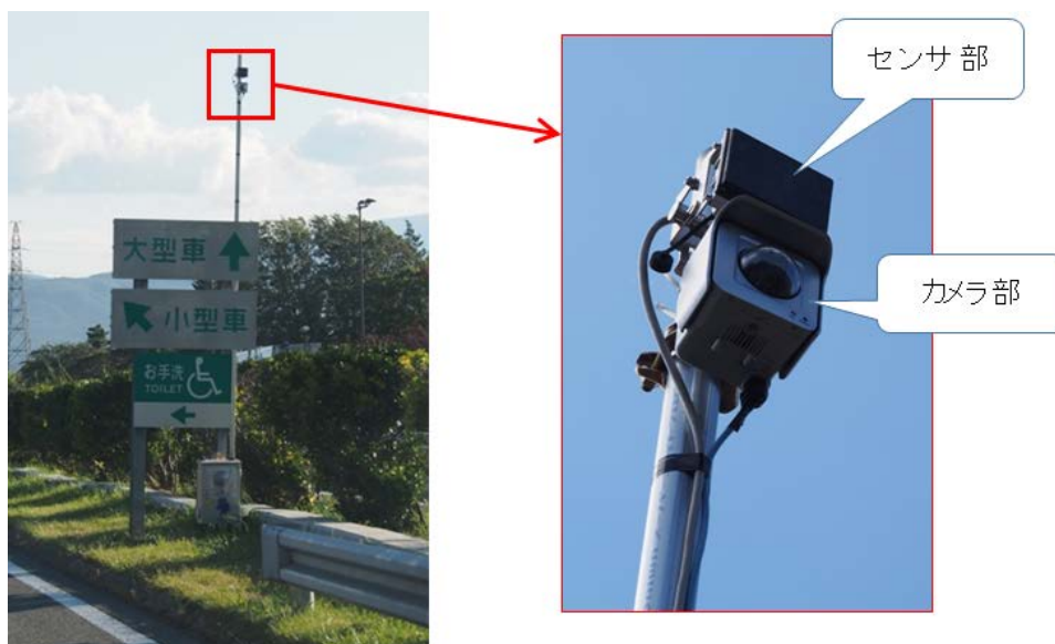
図 4-86 交通流計測用マイクロ波センサの例
