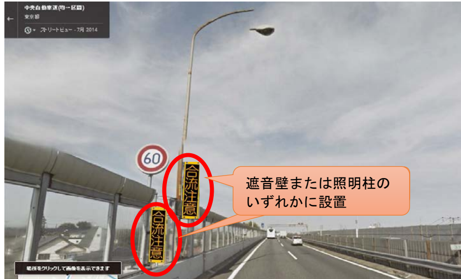
図 4-75 合流部の上流（約 500m）の設置候補位置と情報提供内容（案）
