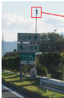
交通流計測用マイクロ波センサの製品例
