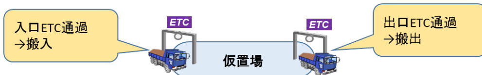
図 2-7 仮置場搬出入確認イメージ
