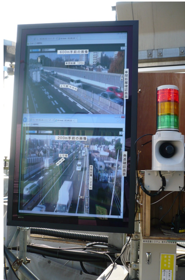
運転手用モニタ画面 (カメラ①③) 発進指示信号機&ブザー
